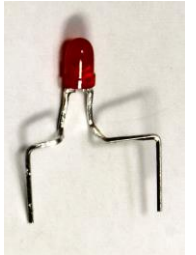
Abgewinkelte Anschlussdrähte von LED4 (Port D5)
